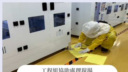
工程組協助處理現場 化學品洩漏
